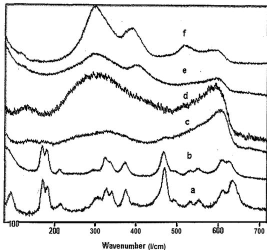
**Fig.1** Raman spectra: a) m-ZrO<sub>2</sub>; b) Sm<sub>0.1</sub>Zr<sub>0.9</sub>O<sub>1.95</sub>; c) Sm<sub>0.2</sub>Zr<sub>0.8</sub>O<sub>1.9</sub>; d) Sm<sub>0.3</sub>Zr<sub>0.7</sub>O<sub>1.85</sub>; e) Sm<sub>0.4</sub>Zr<sub>0.6</sub>O<sub>1.8</sub>; f) Sm<sub>2</sub>Zr<sub>2</sub>O<sub>7</sub>.
